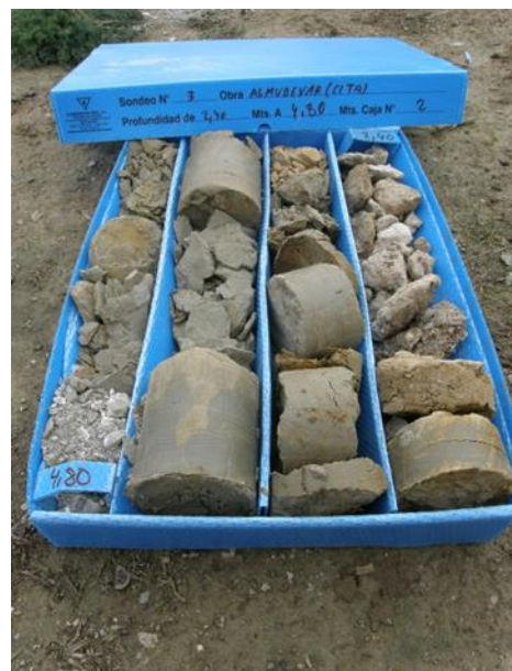
Figura 6. Perforación de sondeos para el estudio y control de los retornos de riego de la CR de Almodévar, Huesca (izquierda). Testigo continuo de un sondeo (derecha).
