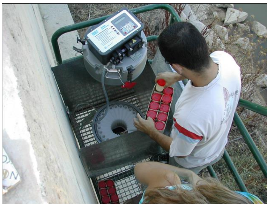
Figura 15. Toma muestras automático con programador. Las muestras hay que recogerlas de forma manual y enviarlas al laboratorio.
