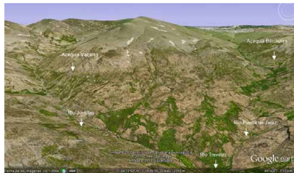
Fotos 1-3. Las acequias se trazan siguiendo las curvas de nivel para la recarga del acuífero superficial (suelos-regolito) y profundo (macizo rocoso fracturado).
