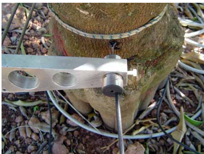
Figura 1. Detalle de un dendrómetro instalado en el tronco de un naranjo
